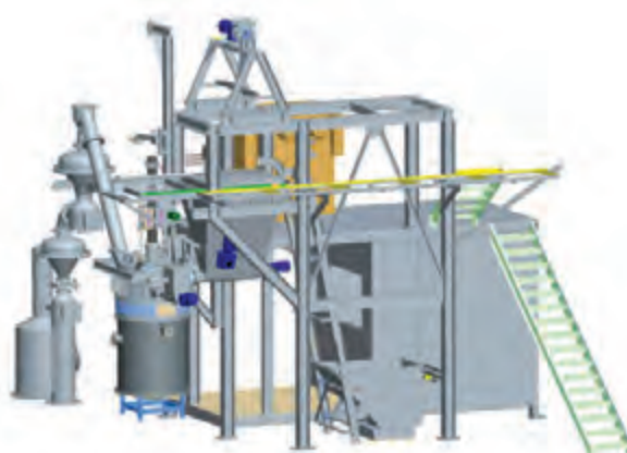
Obr. 1 Náčrt plazmového zariadenia s dávkovaním a čistením plynu
