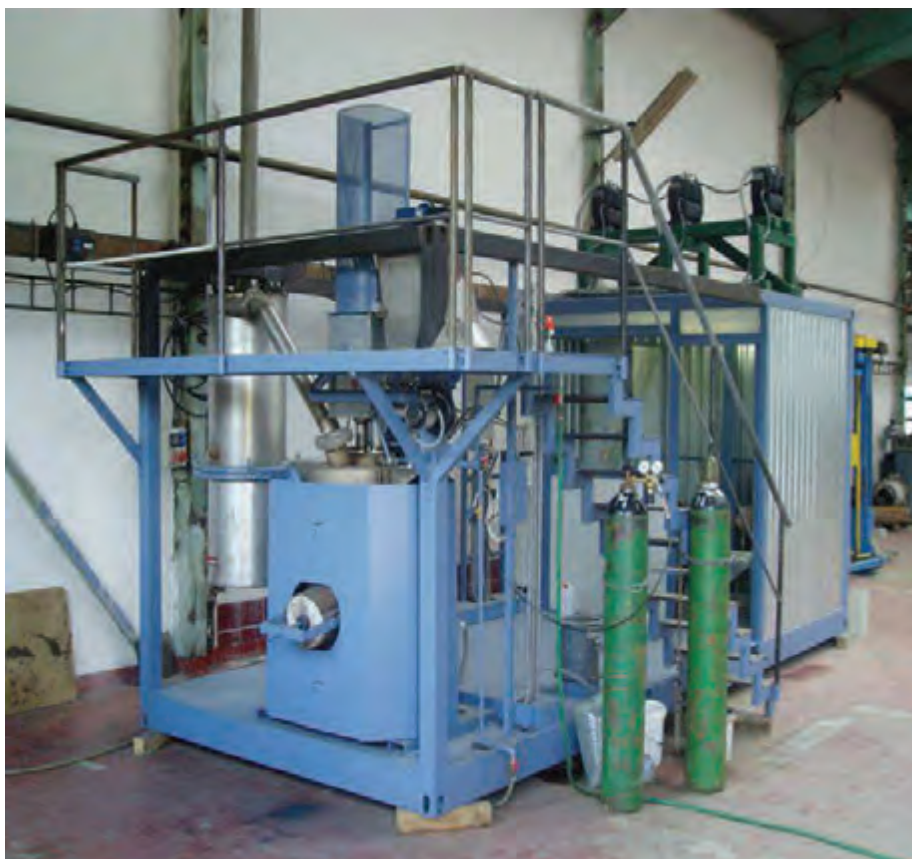
Obr. 4 Plazmové zariadenie na testovanie vzoriek odpadu
