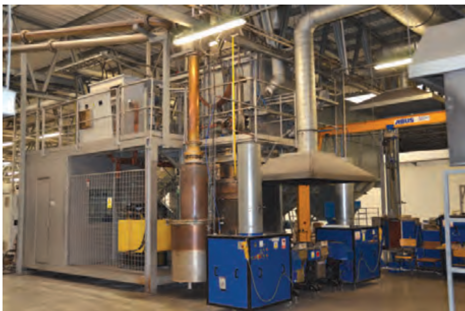
Obr. 2 Plazmové zariadenie na spracovanie elektroodpadu v Poľsku
