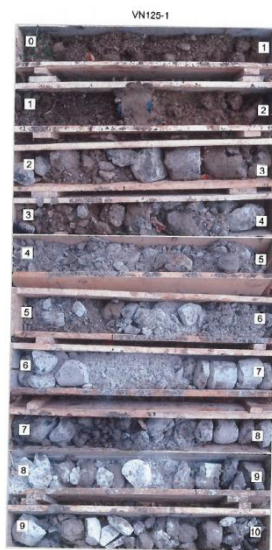
Foto 1: Geologické jadro (vrtný profil) z vrtu VN125-1
