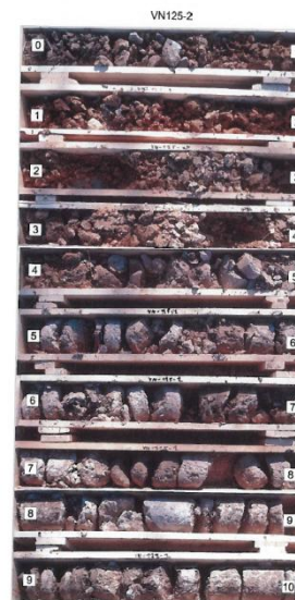
Foto 2: Geologické jadro (vrtný profil) z vrtu VN125-2
